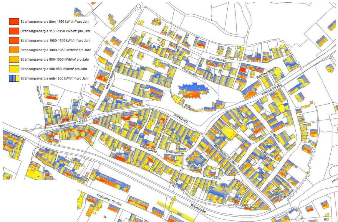
**Abbildung 40:** Dachflächen für PV-Anlagen
